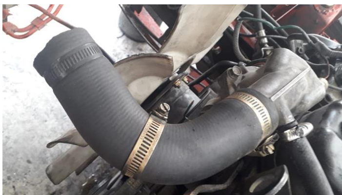
Figura 16 Manguera de Refrigeración
