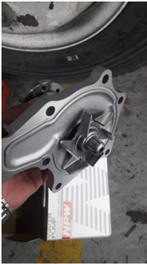
Figura 17 Bomba de Refrigerante NPR
