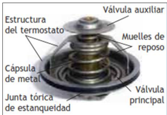
Figura 19 Partes del Termostato
