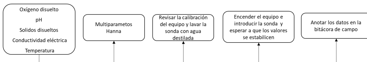
Figura 1 Medición de parámetros In-Situ con equipo multiparámetro
