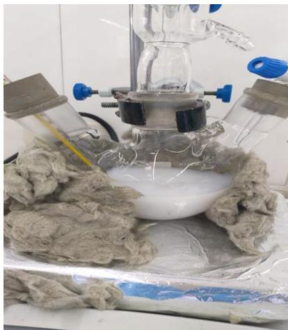
Después de las 8 horas de agitación de la mezcla para dosificación se coloca al matraz en un tiempo de 30 minutos, una vez terminada la dosificación se coloca en un vaso precipitado, hasta que se pueda denotar 2 fases de la mezcla las nano partículas en el fondo y la solución en la parte superior
