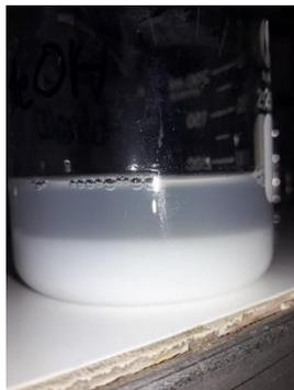
Se deja un día en análisis, luego con ayuda de una jeringa y de manera muy cuidadosa se retira el líquido sin mover las nano partículas, una vez sacado los retantes del vaso precipitado se procede a lavar con agua y metanol y es cambiado a u tubo de centrifugado, se procede a centrifugar de 20 a 30 min a 300 rpms. Una vez centrifugado se coloca en un vaso de reloj marcado y se coloca en el horno para su correcto secado
