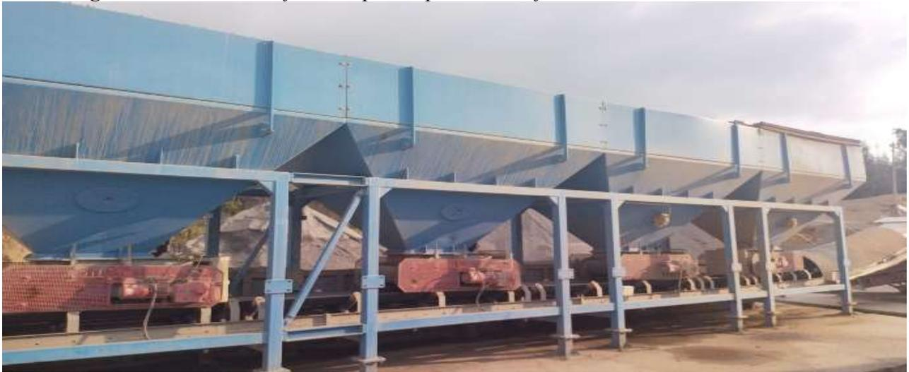
En la Figura 4, se presenta el estado de las tolvas de dosificación previa, en la cual se deposita los agregados para dar inicio al proceso de secado.
