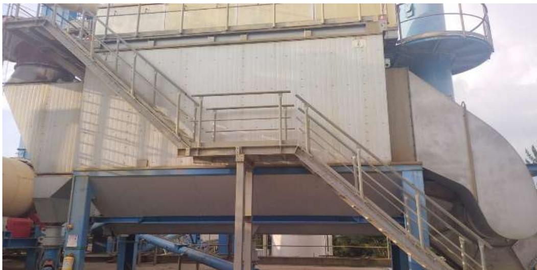
En la figura 9, se presenta el sistema de eliminación de polvos, la cual, cuenta con 352 filtros de mangas, estos filtros generan unos finos para ser reutilizados cuando se produce mezcla asfáltico.
