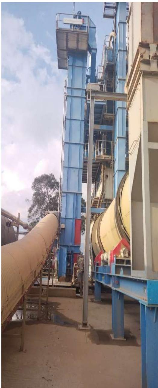
En la figura 6, se presenta el sistema de elevación del material reciclado.
