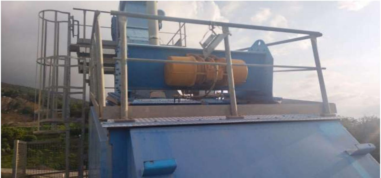
En la figura 1 se ve el estado del sistema Criba, la cual, hace la función de seleccionar los agregados de determinado tamaño.
