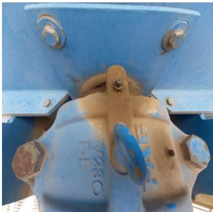
*Figura 31 rodamiento rueda dentada segmentada lado opuesto motorreductor*
