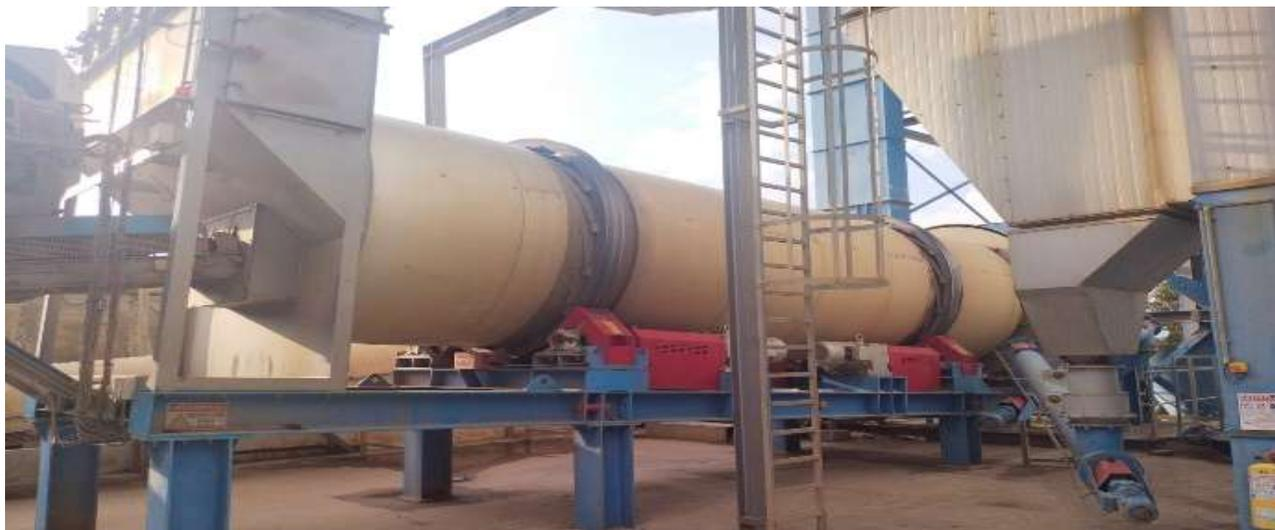
En la figura 10 se muestra el estado del sistema de tambor de secado, en la cual, busca secar y elevar la temperatura del agregado, para dar continuidad al proceso de mezclado.
