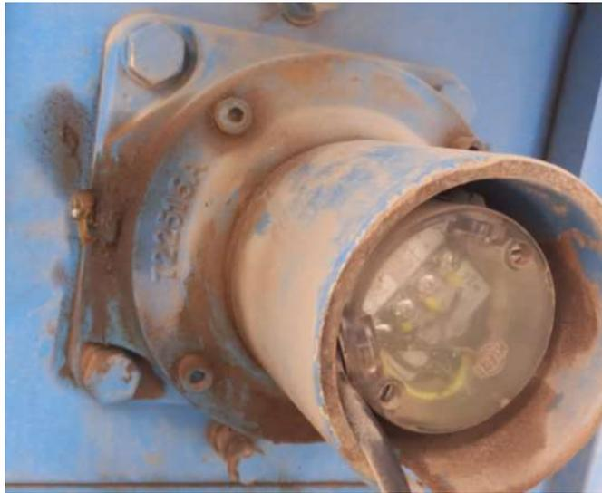
*Figura 27 Chumacera rodamiento rueda segmentada sin dientes*
