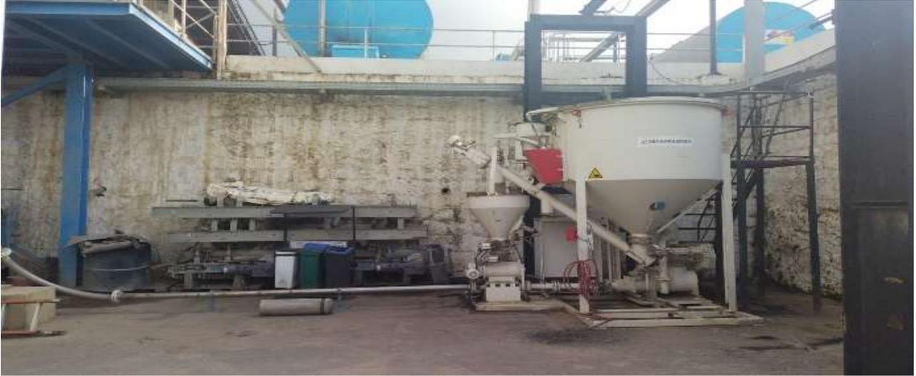
En la figura 5, se presenta el sistema de granulado, el cual, cumple la función de realizar una mezcla de asfalto con caucho reciclado en seco.
