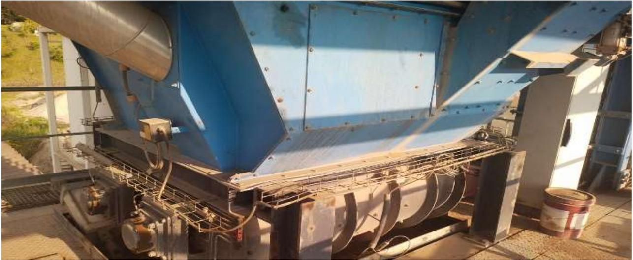
En la figura 3 se aprecia el mezclador de la planta de asfalto, la cual hace la función de mezclar el asfalto junto con el material agregado.
