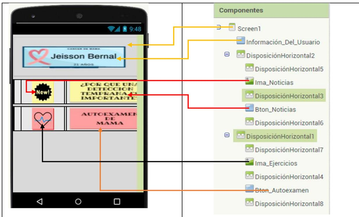
En la Figura 10 se detalla el proceso de la primera pantalla principal de la herramienta, con algunas funciones ya asignadas, además se realiza una selección de componentes específicos, como imágenes, botones y disposiciones, que permiten tener más control y facilidad en la app móvil
