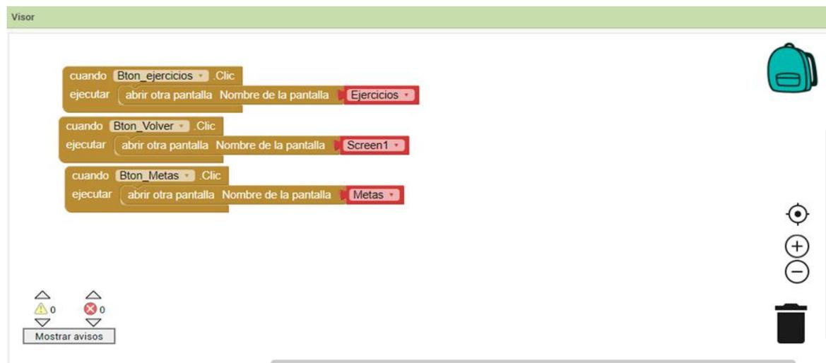
En la Figura 14 se hace una detallada y simple programación de bloques para la pantalla secundaria que permitirá hacer diferentes funciones que el usuario podrá utilizar, en esas funciones se destaca el poder dirigir al usuario a una pantalla con los ejercicios, metas y logros del usuario.
