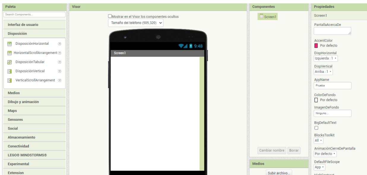
Se trata de una ventana del diseñador en la que se elabora, mediante el ratón, sin necesidad de usar ningún lenguaje de programación, todo el interfaz gráfico que va a tener la aplicación. A continuación, se detallará por secciones (Figura 2) lo anteriormente mencionado.
