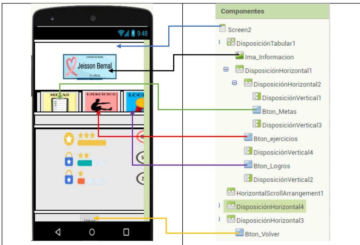
En la Figura 13 se detallan los componentes seleccionados para la pantalla secundaria de la herramienta en desarrollo, además relacionamos los componentes con las secciones colocadas en la pantalla de simulación
