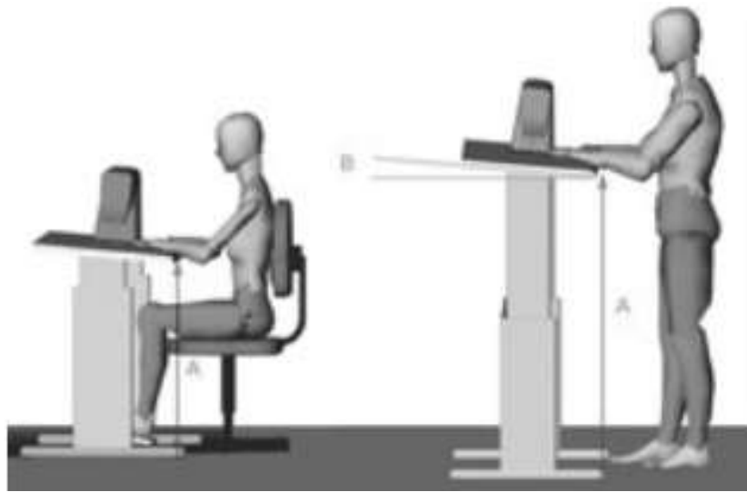
Ilustración 5 Alturas de trabajo.
