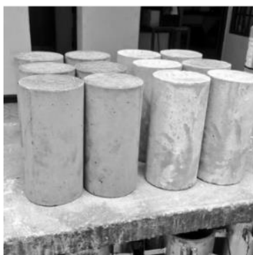
Cilindros de concreto de 6"
