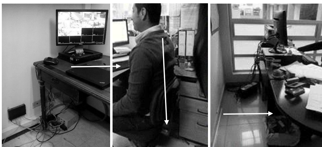
Ilustración 28. Puesto de trabajo TIC, sillas no ergonómicas, cables expuestos, sin reposapiés (fuente propia).
