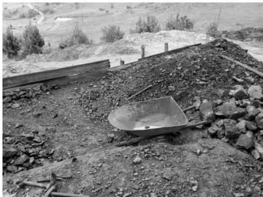
Fotografía 2. Ayuda mecánica (carretilla) utilizada para la movilización del mineral (carbón) y material estéril
