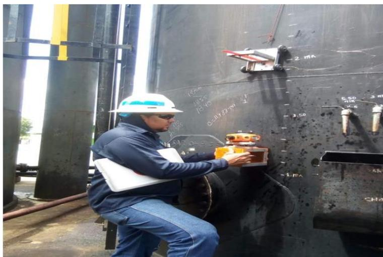
Se observan el carro magnético, el cual debe moverse a lo largo del tanque para con la plomada óptica ir midiendo la verticalidad del tanque según procedimiento de calibración. Este carro magnético está sostenido por una manila y el técnico que se encuentra arriba del tanque lo va moviendo.
