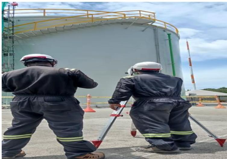
Se Puede observar que usando una estación total no hay ningún técnico en la parte superior del tanque, se elimina por completo el trabajo en alturas, y además se minimiza el golpe térmico producido por la temperatura de lámina del tanque, siendo que el trabajador que mide la verticalidad puede alejarse del tanque para proceder a la toma de medidas.
