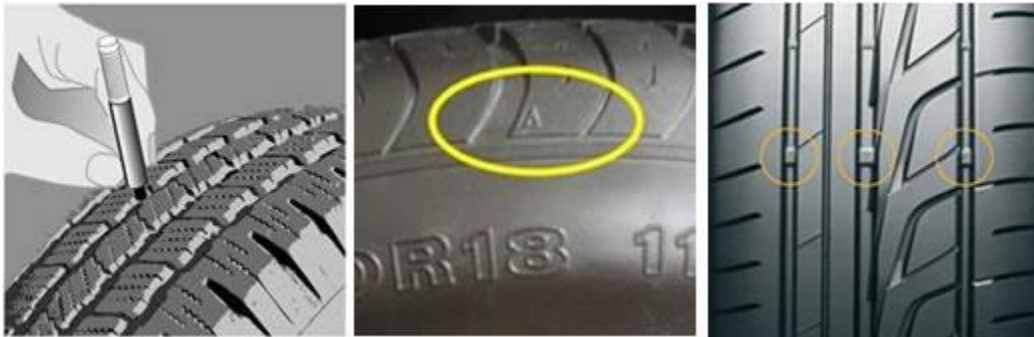
Figura 8. Indicadores de desgaste de la rueda. Imagen tomada de sitio web virtuallantas.com/profundidad-banda/
