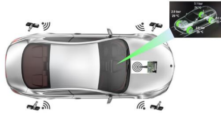
Figura 9. Sistema de TPMS en el vehículo. Imagen tomada de (WORLD, s.f.)
