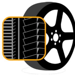
Figura 3. Labrado asimétrico de la rueda. Imagen tomada de (CONTINENTALTIRE.COM, s.f.)
