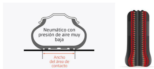
Figura 6 Neumáticos con baja Presión. Imagen tomada de (ROMÁN, 2015).
