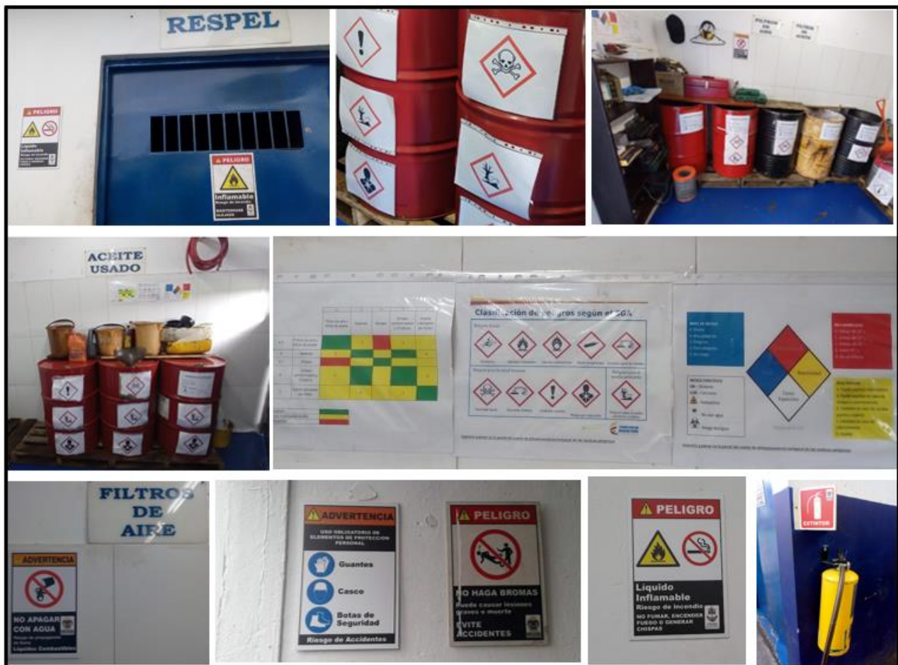
Figura 4. Cuarto de almacenamiento de RESPEL señalizado.
