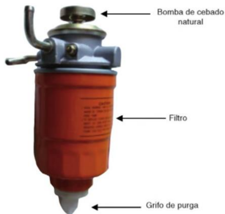
Ilustración 9. Bomba de cebado manual para sistema de inyección Kia Carnival. (Gonzalez, Mantenimiento de sistemas auxiliares del motor de ciclo diesel, 2015)
