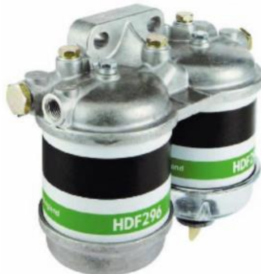
Ilustración 7. Conjunto filtro y sedimentador independientes. (Gonzalez, Mantenimiento de sistemas auxiliares del motor de ciclo diesel, 2015)
