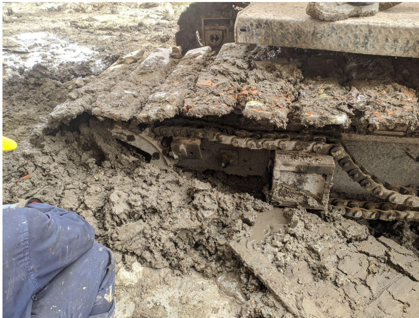
Ilustración 8: Falla de cadenas de transmisión debido a terreno piloteadora Link Belt LS 118 (Fuente: Propia).
