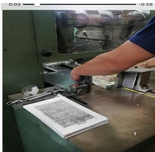
Figura 5. No uso de elementos de protección.
