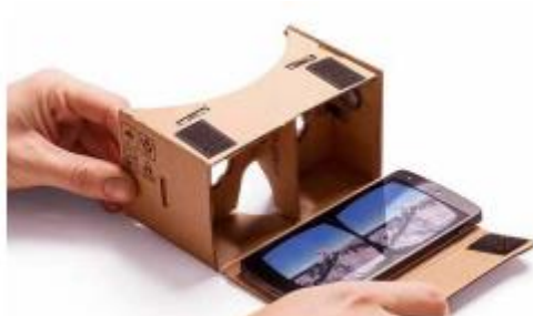
Figura 2 Funcionamiento de las Google Cardboard. Fuente: Mouze Alandete, J. J. (2019)
