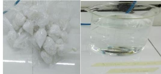
utilizando tres tipos de concentración de soda caustica diferentes una de 2% NaOH/98% agua, 6% NaOH /94% agua y 9% NaOH /91% agua, se logra una limpieza de la fibra de fique obteniendo un ph neutro (7), luego se lleva al horno para su secado a 110°celsius por dos horas.
