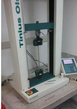
Con un total de nueve probetas listas las trasladamos para la maquina universal de ensayos Tinus Onsel para someterlas cada una a un ensayo a tracción el cual
