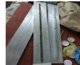
debe separar el molde de las probetas y a la vez limpiar nuevamente para realizar una nueva probeta, cada una de estas toman un diseño fisico diferente debido a la cantidad de fique aplicado, por lo que se puede notar a simple vista.
