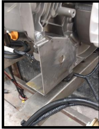
Gráfica 4.18: Soporte metálico de la cremallera. Fuente: Autores. Véase anexo S
