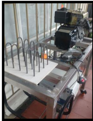
Grafica 4.6: Banco de Resistencias (freno de motor) Fuente: Autores. Véase Anexo S
