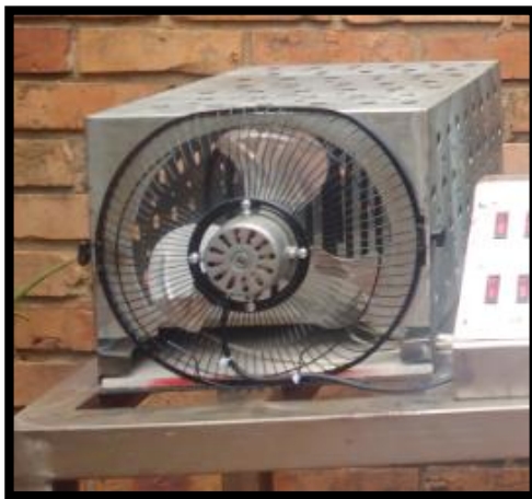
Gráfica 4.8: caja de protección del banco de resistencias Fuente: Autores Véase Anexo S
