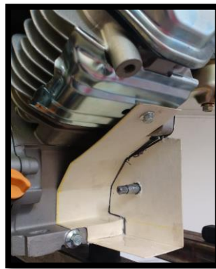
Gráfica 4.17: Plantilla de la base cremallera. Fuente: Autores. Véase anexo S
