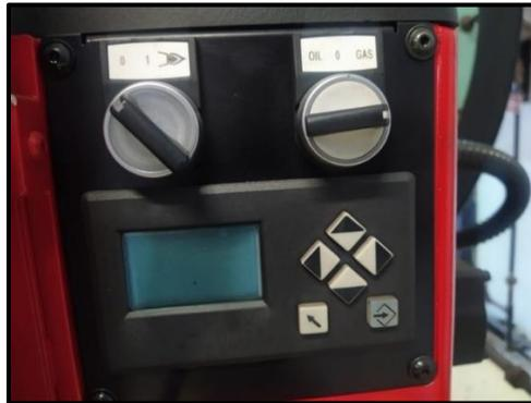
*Figura 47: Pantalla de control del Quemador*
