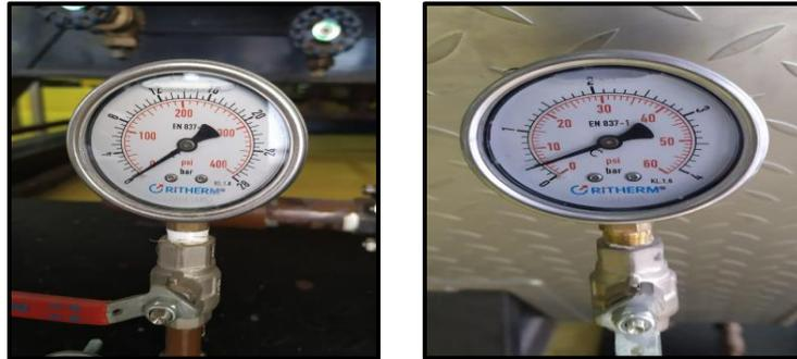
*Figura 20: Manómetro entrada después de regulador (2-5PSI) –
