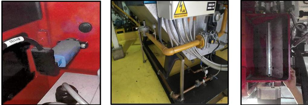
*Figura 16: Fococelda – Regulador de gas, filtro y válvula, Servomotor*
