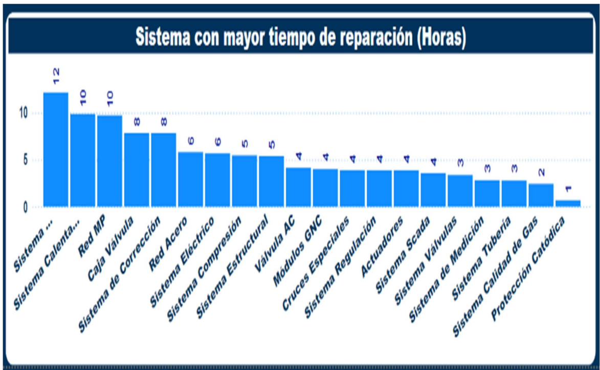
Figura 24 Vista Sistema con mayor tiempo de reparación
