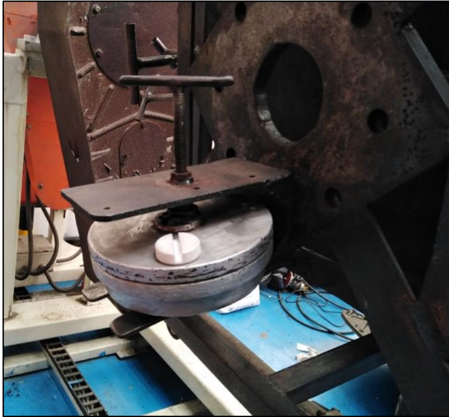
Figura 24. Anclaje de molde.
