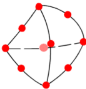
Ilustración 9. Representación de Nodos en el FEM, (SolidWorks, 2022).
