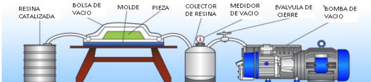
Figura 5. Proceso de infusión al vacío. (McDANIEL & CHASE, 2014)
