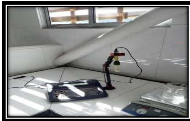
Figura 26. pH metro marca Hanna utilizado para medir y reajustar el pH de las muestras de Ilmenita de origen colombiano tomadas del yacimiento de Barbacoas Nariño. (Fotos tomadas en el laboratorio de la universidad ECCI 6 piso fuente propia).
