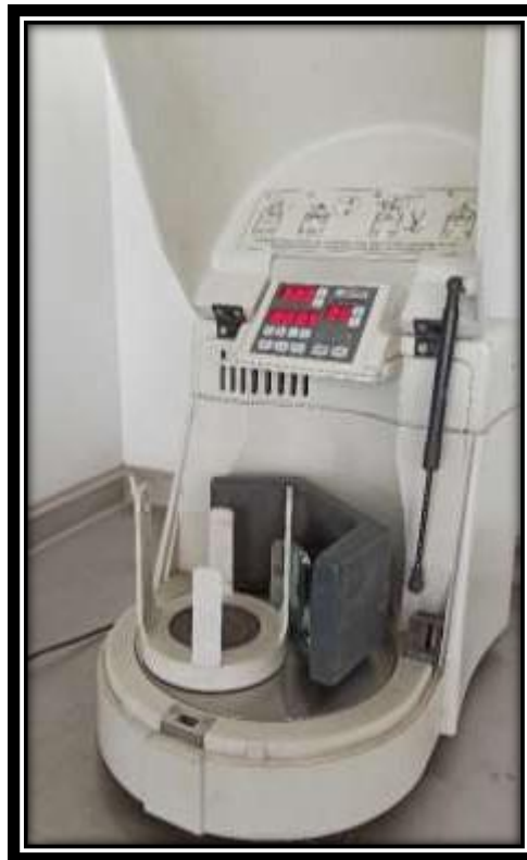
Figura 22. Molino de bolas planetario marca Fritsch ubicado en el laboratorio en la sala de Vicerrectoría de investigación en las instalaciones de la universidad ECCI(U.ECCI).
