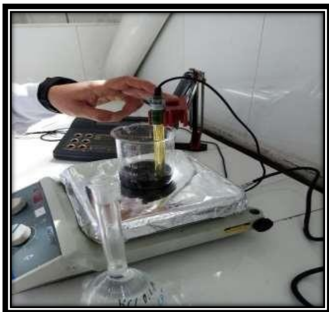
Figura 27. Medición del pH.(pH metro hanna ubicado en la universidad ECCI).
