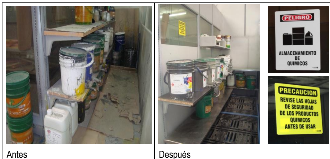
Figura 17. Fotografía Sitio de almacenamiento de pintura líquida, antes y después.
