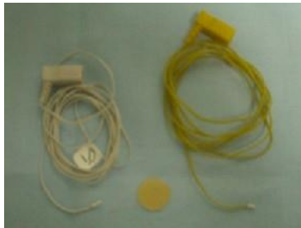
Figura 5: electrodos Tª periférica y central cutánea (Incubadora Dräger 8000)
