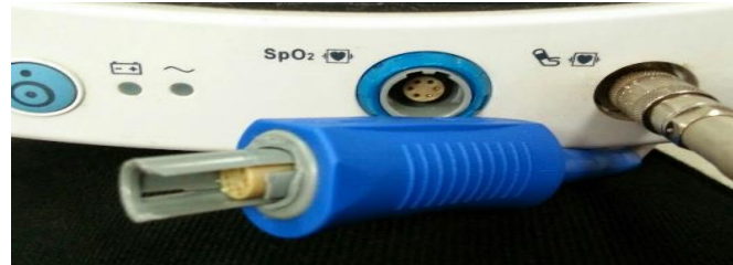
Fotografía 31. Conector de pinza de SPO2 dañada.
