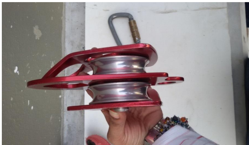
Ilustración 8. Sistema de acceso de herramientas se realiza el tránsito vertical de la herramienta por medio de un sistema de polea sencilla con una cuerda para tal fin de forma independiente a sus equipos de protección individual.
