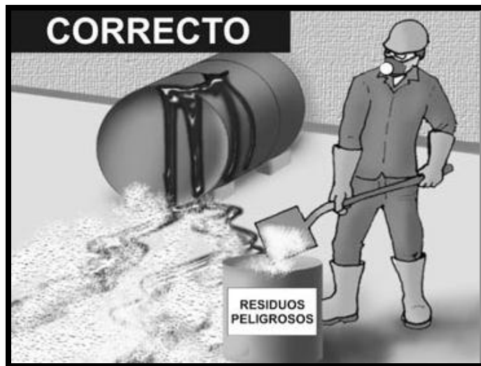
Ilustración 27 Contingencia de derrames "Recuperación Zona Afectada"
