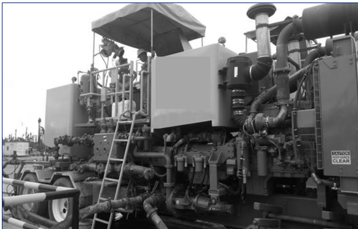
Figura No. 16 Unidad de Cementación
