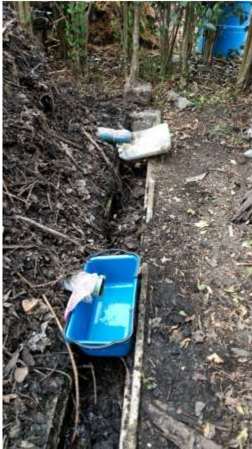
Ilustración 74. Canecas para la recolección de lixiviados. Fuente: Autor
