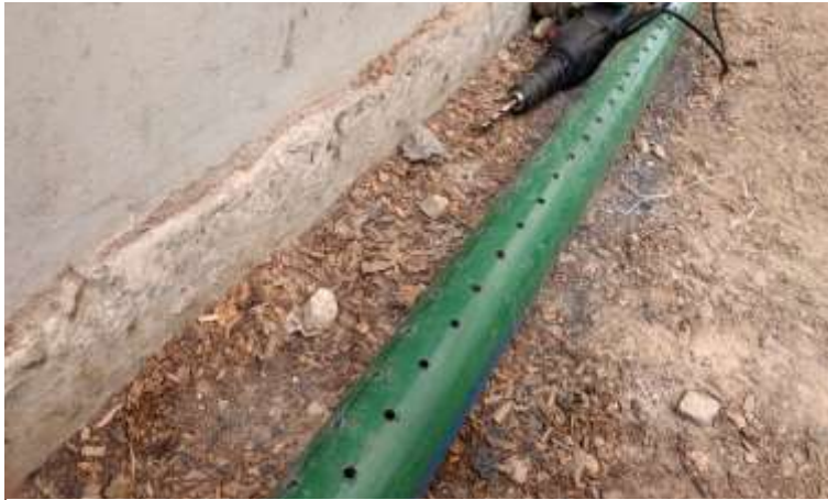
Ilustración 33. Tubo adaptado para recolección de lixiviados.
