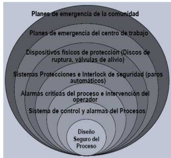
FIGURA 6. CAPAS DE PROTECCIÓN EN SEGURIDAD DE PROCESOS. FUENTE: GUÍA DUPONT 110.1.
