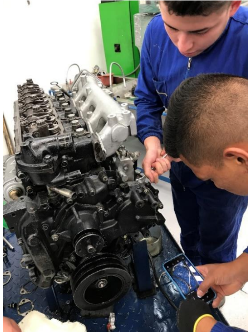
Ilustración 27.Desensamble bomba de inyección 2. (Del autor).
