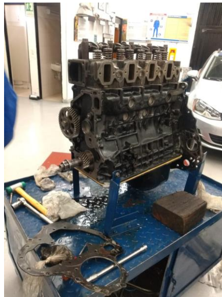
Ilustración 54. Ensamble de cárter y culata con el bloque. (Del autor)
