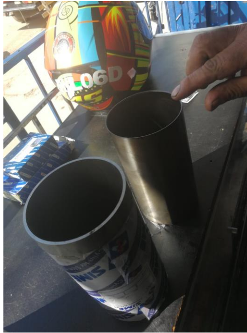
Ilustración 47. Camisas nuevas. (Del autor).
