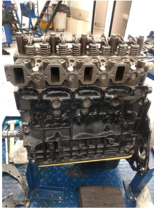
Ilustración 55. Puesta en bases del motor. (Del autor).
