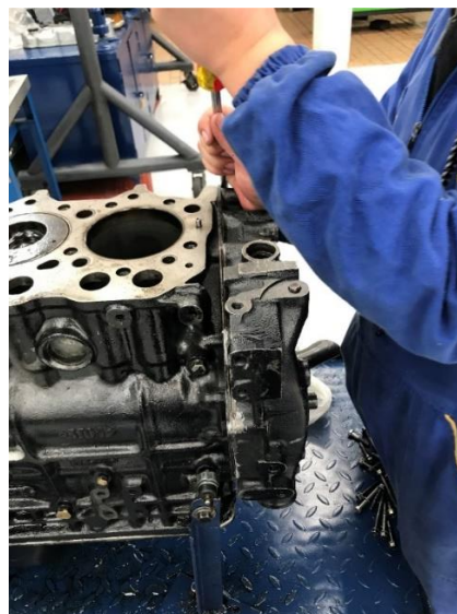
Ilustración 37. Extracción tapa de la distribución. (Del autor).
