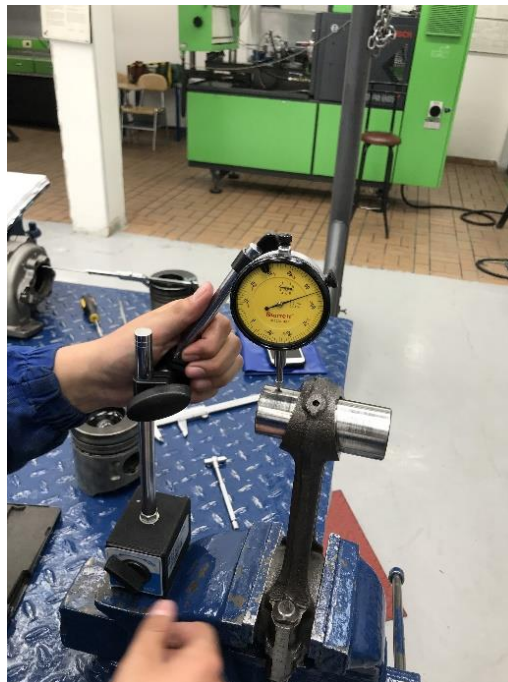
Ilustración 43. Juego entre bulón y orificio superior de la biela. (Del autor).
