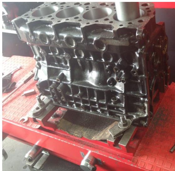
Ilustración 52. Bloque siendo encamisado 2. (Del autor).
