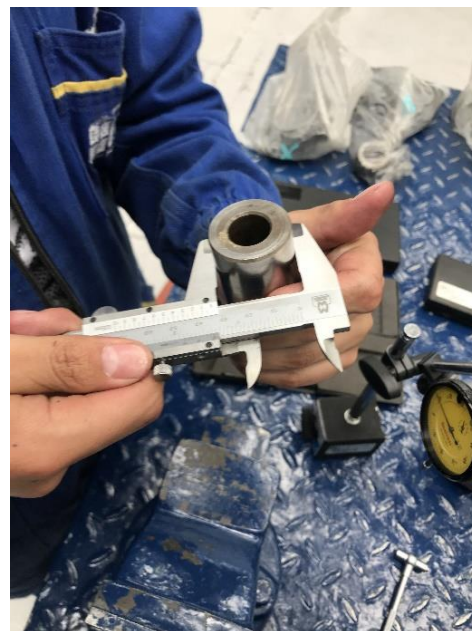
Ilustración 41.Medida diámetro de bulón. (Del autor).
