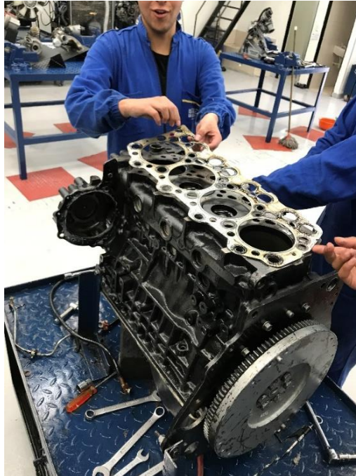
Ilustración 35. Extracción empaque de culata. (Del autor).
