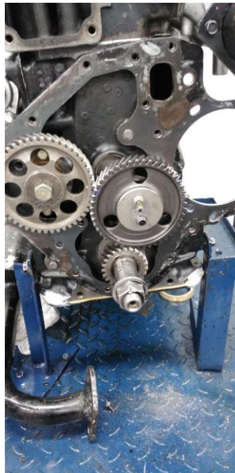
Ilustración 56. Puesta en tiempo del motor. (Del autor).
