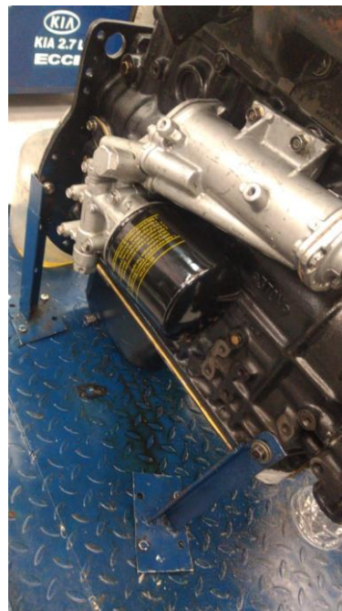
Ilustración 58. Filtro de aceite nuevo puesto. (Del autor).
