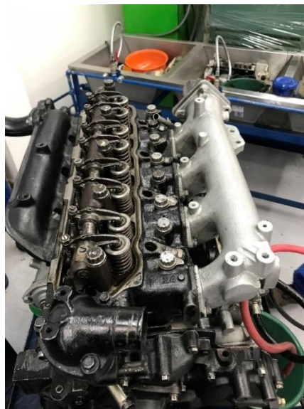
Ilustración 25.Vista superior culata. (Del autor).
