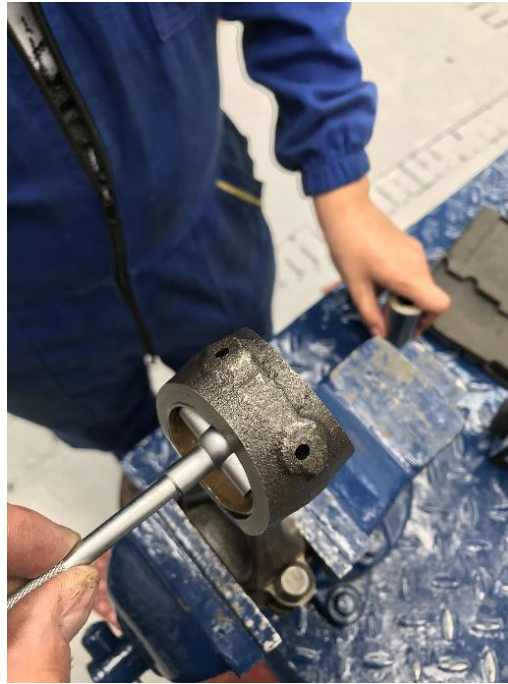
Ilustración 42. Diámetro interior de la parte superior de la biela. (Del autor).
