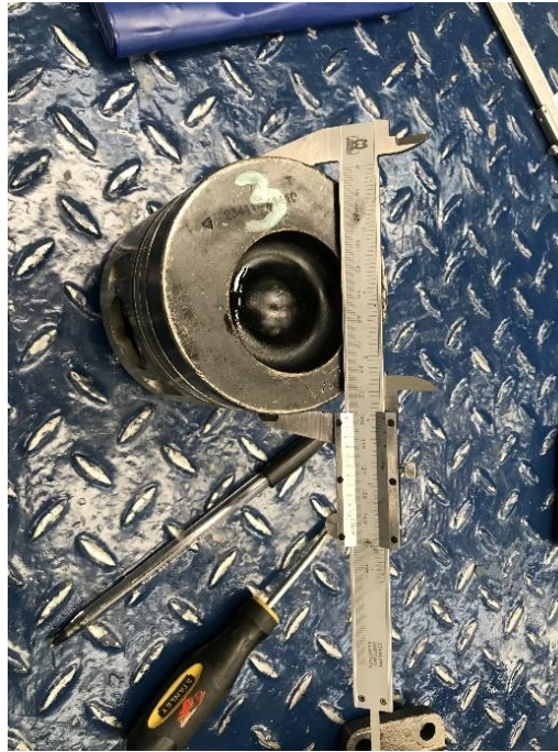
Ilustración 44. Diámetro cabeza de pistón. (Del autor).
