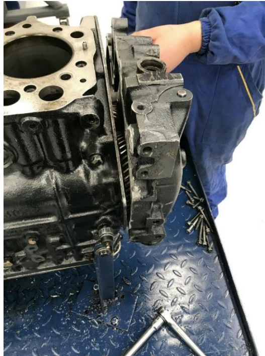
Ilustración 38. Extracción tapa de distribución 2. (Del autor).
