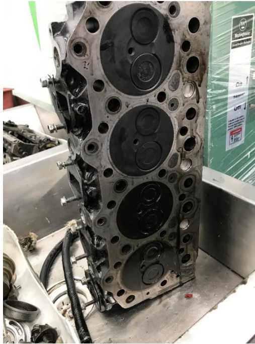
Ilustración 34. Culata Vista inferior. (Del autor).
