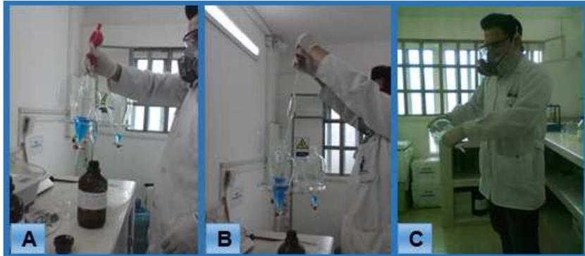
**Figura 16:** (A) y (B) Adición de la solución lavadora. (C) Agitación de la muestra.
