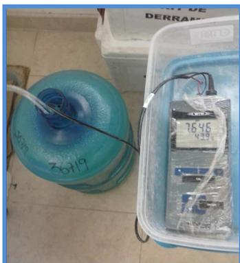
**Figura 27:** Neutralización de la muestra.
