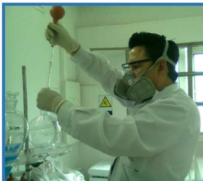
**Figura 15:** Adición de cloroformo al embudo para extracción.
