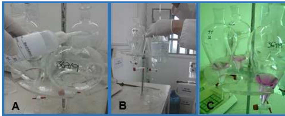
**Figura 9:** Proceso de titulación con NaOH 1N. (A) Adición de fenolftaleína. (B) Titulación (C) coloración de la muestra.
