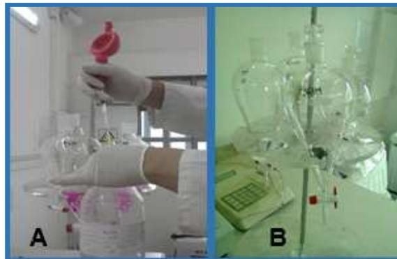
**Figura 10:** (A) Adición de  $\text{H}_2\text{SO}_4$  1N. (B) Eliminación de la coloración.
