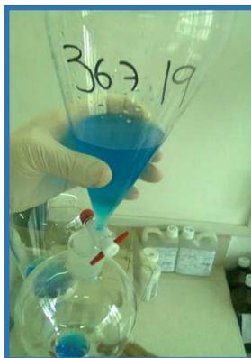
**Figura 14:** Drenaje de fases al siguiente embudo.
