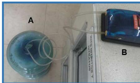
**Figura 24:** Inyección de oxígeno a la muestra. (A) muestra. (B) Aireador.
