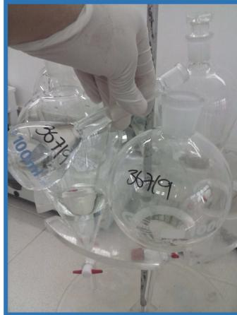
**Figura 8:** Adición de la muestra al embudo de separación
